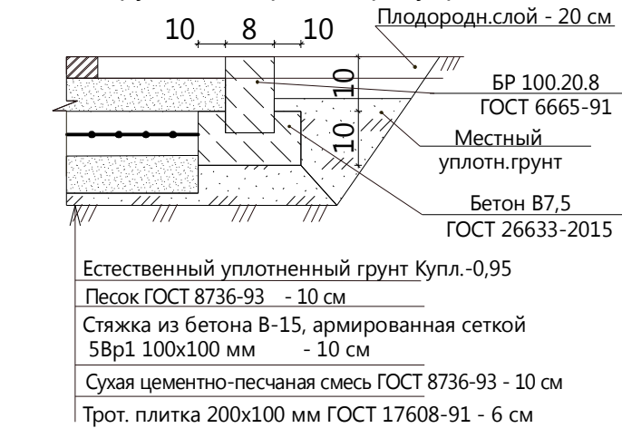
Конструкция покрытия тротуаров. Тип II
