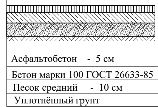
Конструкция откоски
