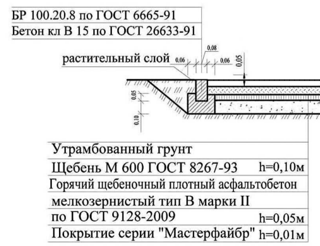
Покрытие детской и физкультурной площадок "Мастерфайбр"
