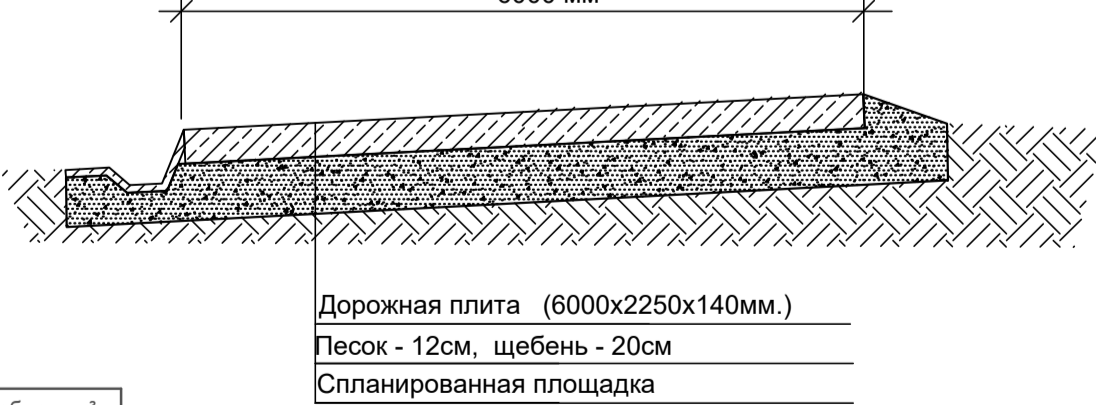
Конструкции временной дороги 6000 мм
