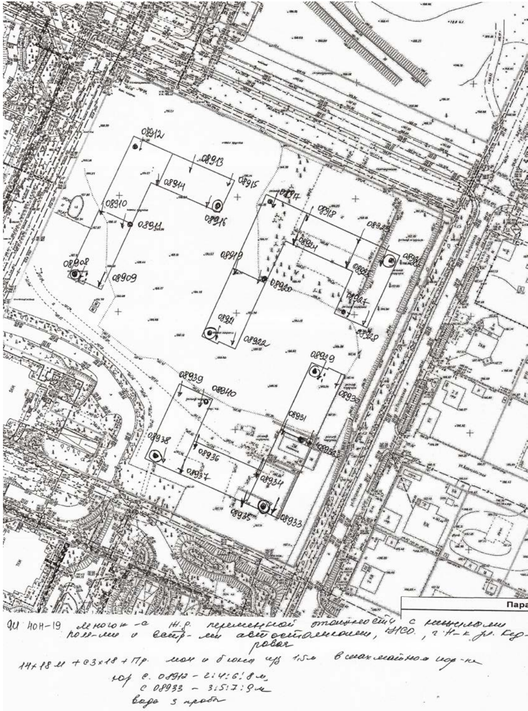
Рис. 6.1 – Схема расположения проектируемых скважин
