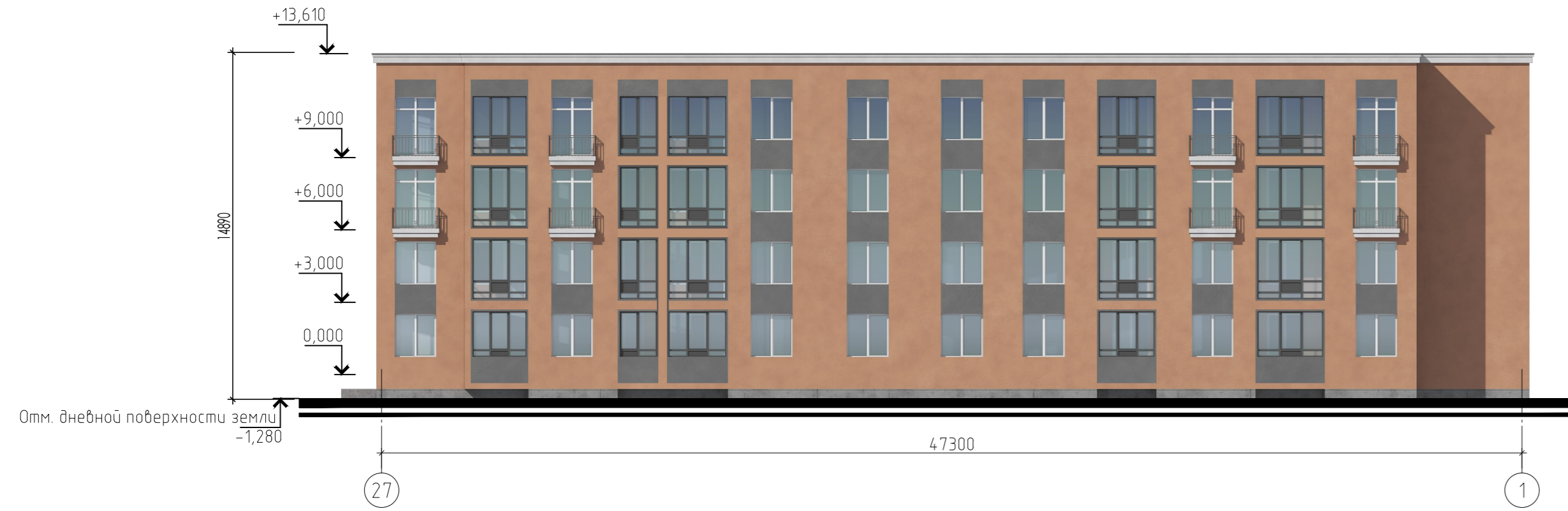
Фасад в осях 27-1
