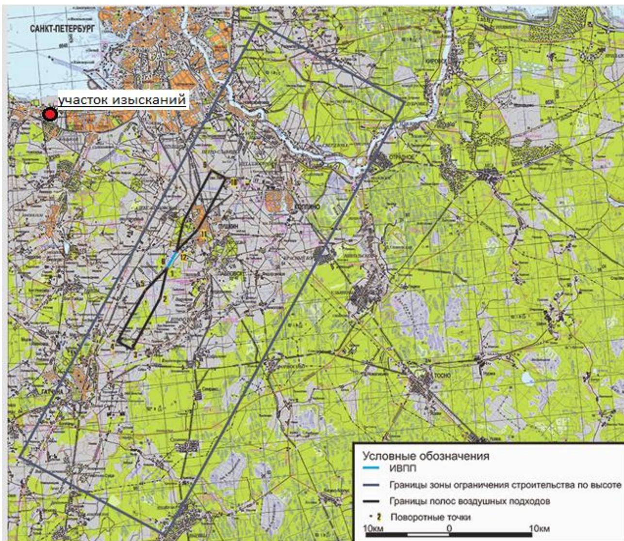
Рисунок 5.4 – Схема границ полос воздушных подходов, зон ограничения строительства по высоте аэродрома Пушкин
