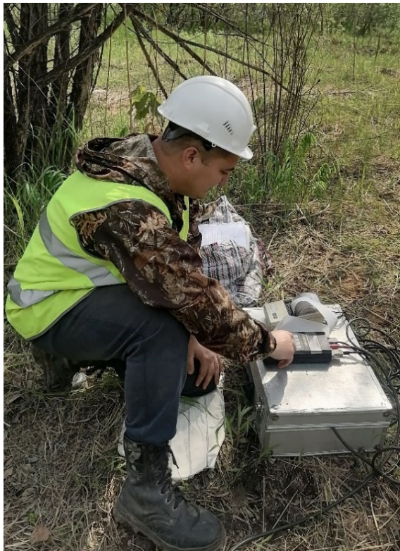
Рисунок 3 – Опыт статического зондирования грунтов вблизи скважины 5Т
