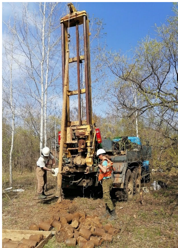
Рисунок 2 - Бурение инженерно-геологических скважин
