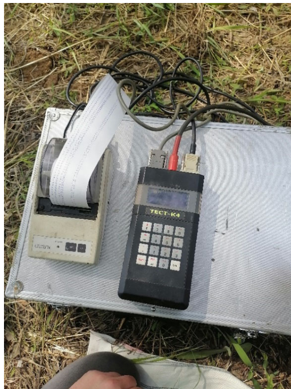
Рисунок 3 – Опыт статического зондирования грунтов вблизи скважины 5Т
