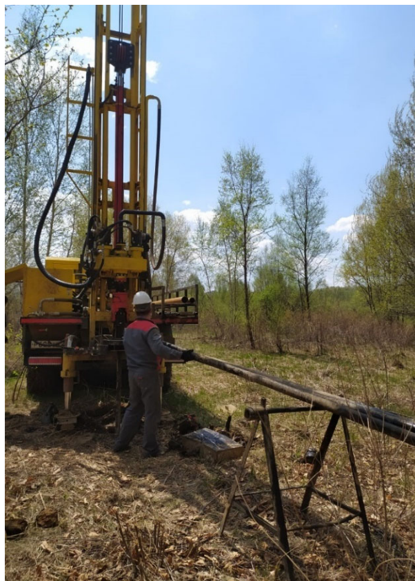
Рисунок 2 - Бурение инженерно-геологических скважин
