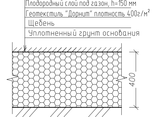
Пожарный проезд (тип 7)
