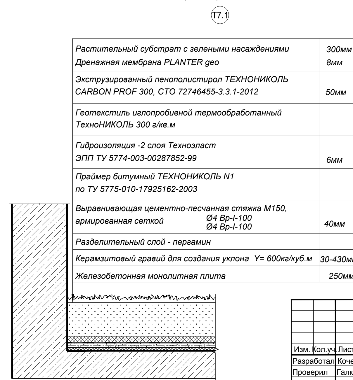
Отмостка, скрытая под растительным слоем по кровле гаража
