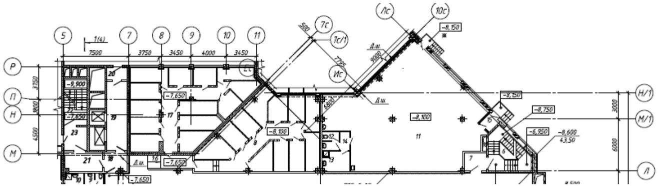
**Многokвартирный дом № 2.** Количество этажей в объекте: 29. Общая площадь объекта: **16 263,90 кв. м.** Материал наружных стен и каркаса объекта: **монолитный железобетонный каркас со стенами из мелкоштучных каменных материалов (блоки «Теплостен»).** Материал перекрытий: **монолитный железобетон.** Высота потолка: **не менее 2,75 м.** Класс энергоэффективности: **A+(очень высокий)** Сейсмостойкость: **6 баллов**
