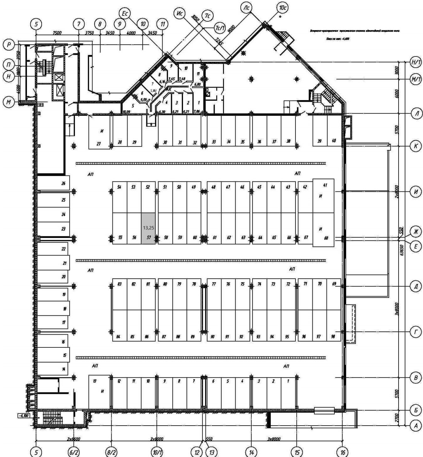
**ПРИСТРОЕННАЯ ТРЕХЭТАЖНАЯ СТОЯНКА АВТОМОБИЛЕЙ ЗАКРЫТОГО ТИПА.** Количество этажей в объекте: 3. Общая площадь объекта: 10 506,00 кв. м. Материал наружных стен и каркаса объекта: монолитный железобетонный каркас со стенами из мелкозернистых каменных материалов. Материал перекрытий: монолитный железобетон. Сейсмостойкость: 6 баллов.
