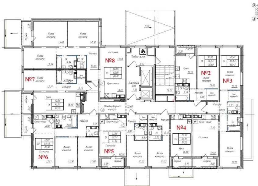
План отделочных работ 2 этажа
