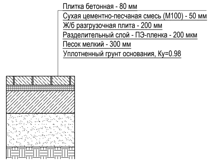
Тротуар с возможностью проезда (16 т/ось). Тип 1.1
