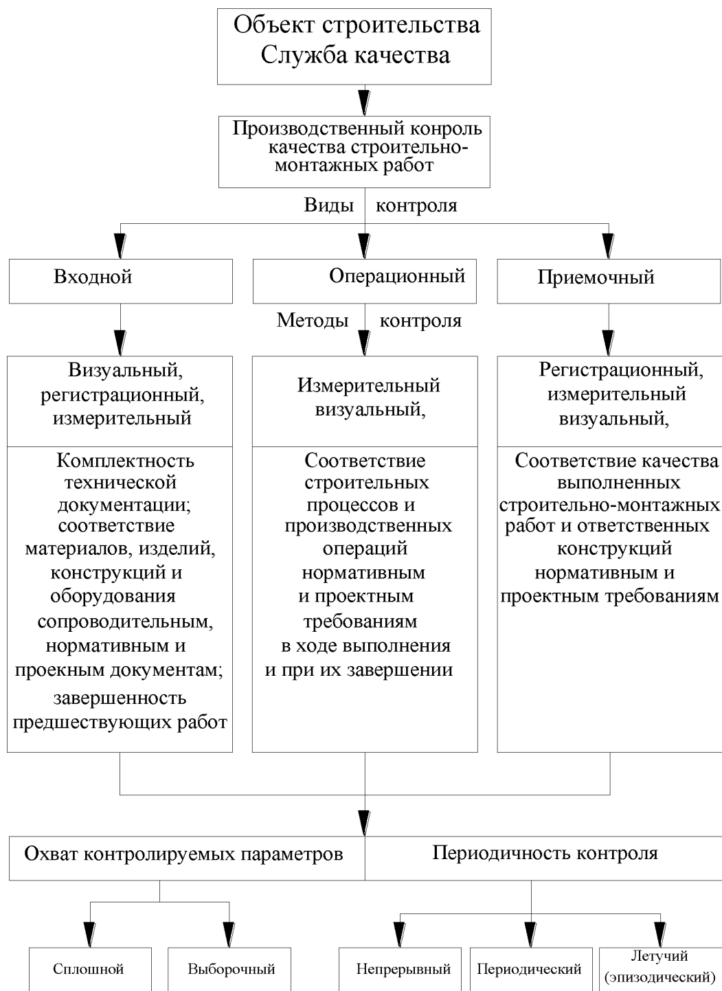
Рисунок 2. Схема производственного контроля качества строительно-монтажных работ
