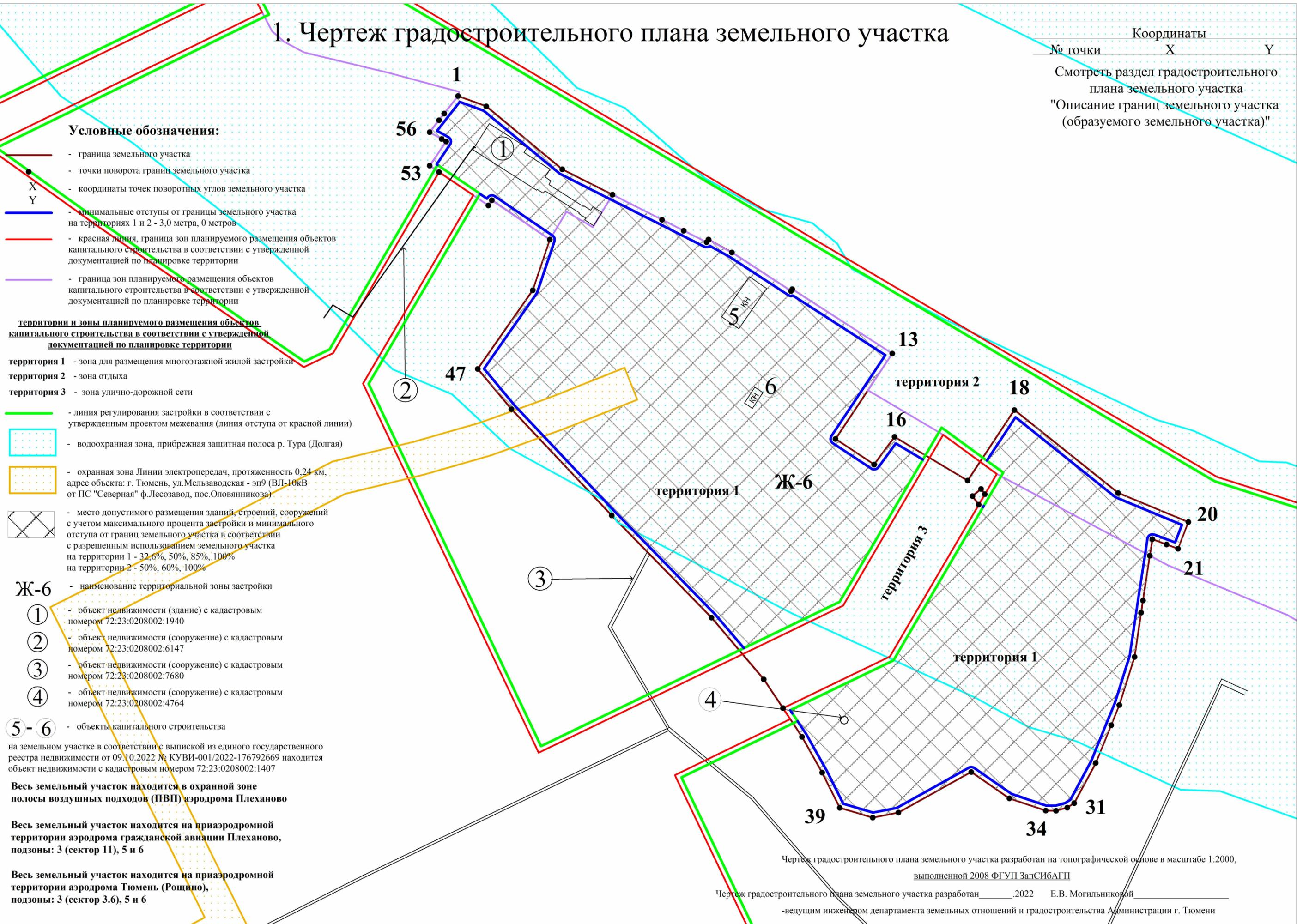
Чертеж градостроительного плана земельного участка разработан на топографической основе в масштабе 1:2000, выполненной 2008 ФГУП ЗапсибГАП
