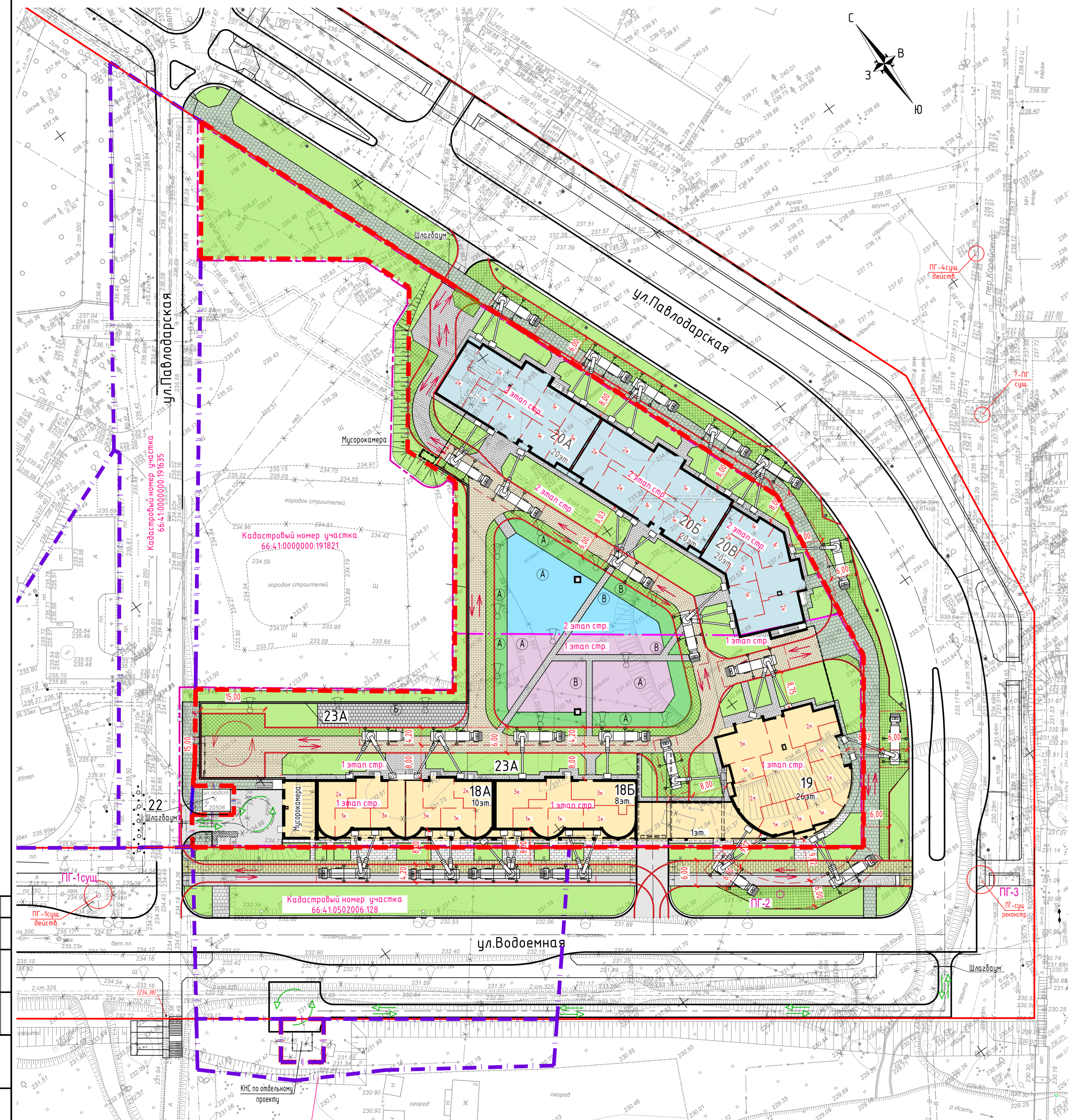
Схема движения машин МЧС и машин для обслуживания ТП и КНС, М1:500
