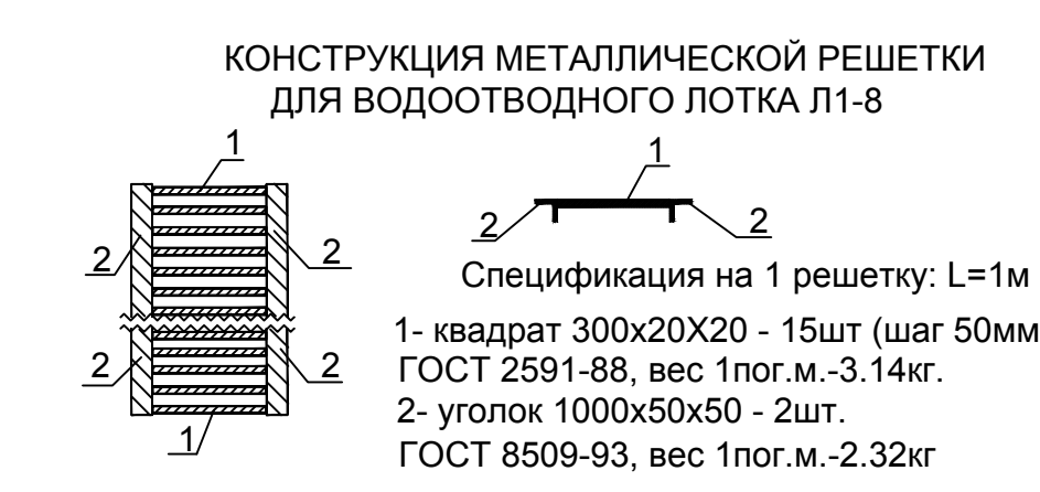
Песок ГОСТ 8736-2014 Н=0,10м Сборный железобетонный лоток П 1-8 серия 3.006.1-2.87 Металлическая решетка, см. деталь
