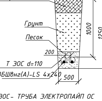
Прокладка кабеля в земле открытым способом
