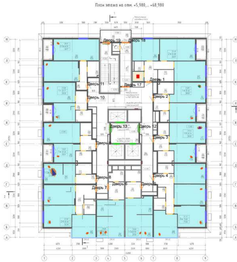
Рисунок 8. Типовой этаж. Расположение людей через 204,6 с после начала пожара
