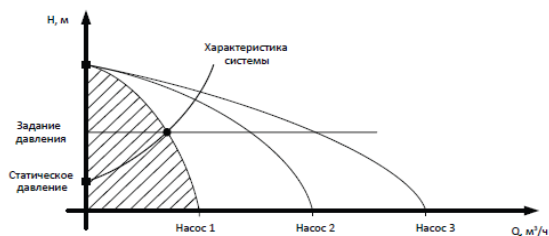
Рисунок 12. Релейное регулирование. Работа одного насоса.
