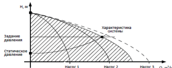
Рисунок 11. Работа одного насоса, производительность которого регулируется частотным преобразователем и двух насосов с номинальной производительностью.
