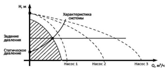
Рисунок 8. Работа одного насоса, подключенного к преобразователю частоты.
