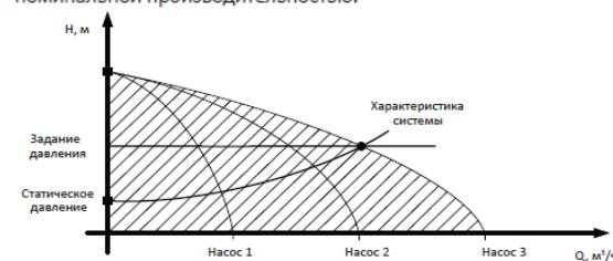
Рисунок 11. Работа одного насоса, производительность которого регулируется частотным преобразователем и двух насосов с номинальной производительностью.
