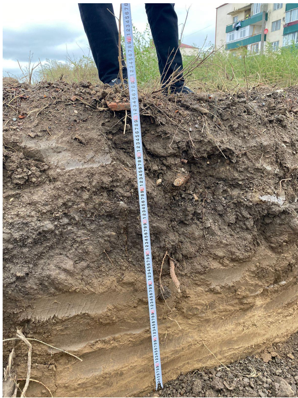
Рисунок 3 – Строение техногенного грунта участка изысканий
