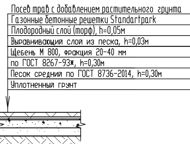
9 тип - укрепленный газон (бетонная решетка)
