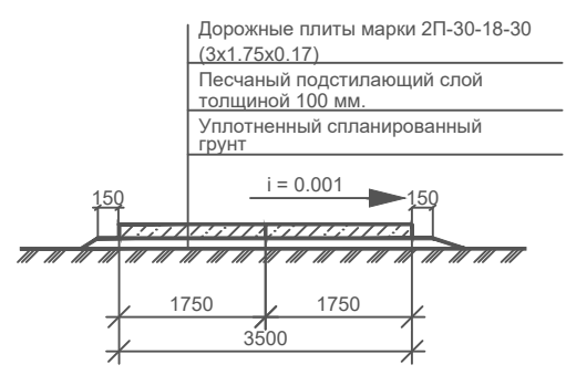
КОНСТРУКЦИЯ ВРЕМЕННЫХ ДОРОГ А-А
