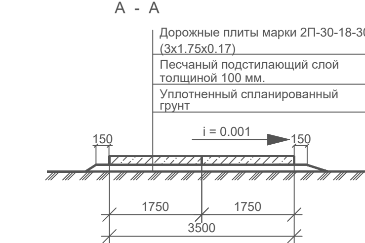
КОНСТРУКЦИЯ ВРЕМЕННЫХ ДОРОГ
