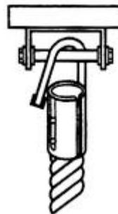
Лопнул сварной шов крепления каната
