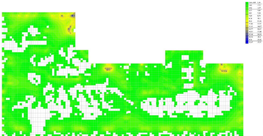
Рис 7.2.7 Верхнее продольное армирование AS4, см 2 /м
