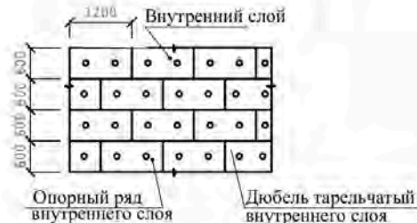
Схема установки внутреннего слоя
