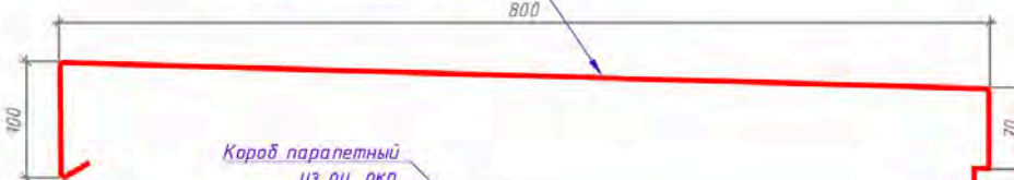
(Цоколь) Нащельник из оц. окр. стали t \geq 0,55 мм (вылет 210 мм)
