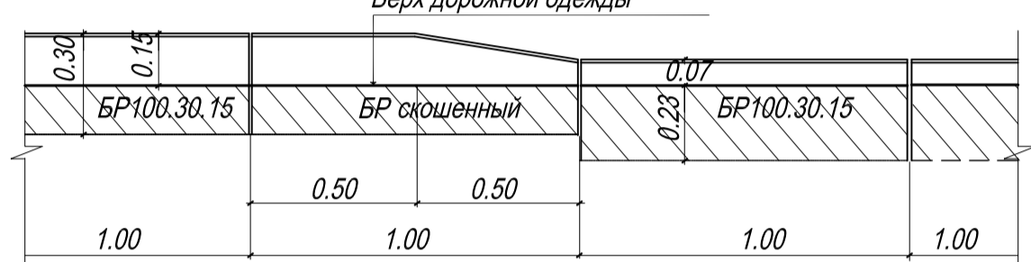
Схема установки пониженных бортовых камней
