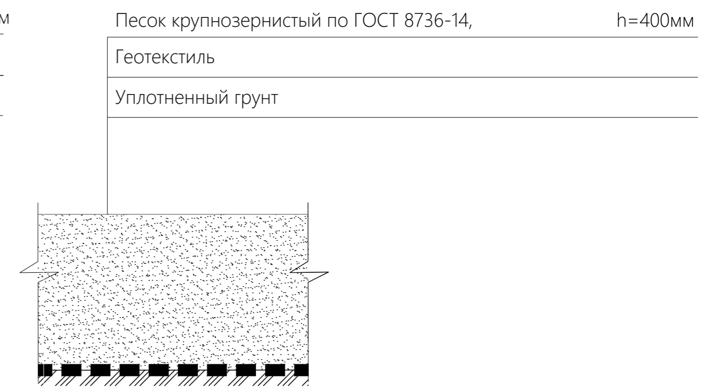
Тип 5 (покрытие детской площадки песчаное) (безопасная h_{\text{падения}}=3.0\text{м} )
