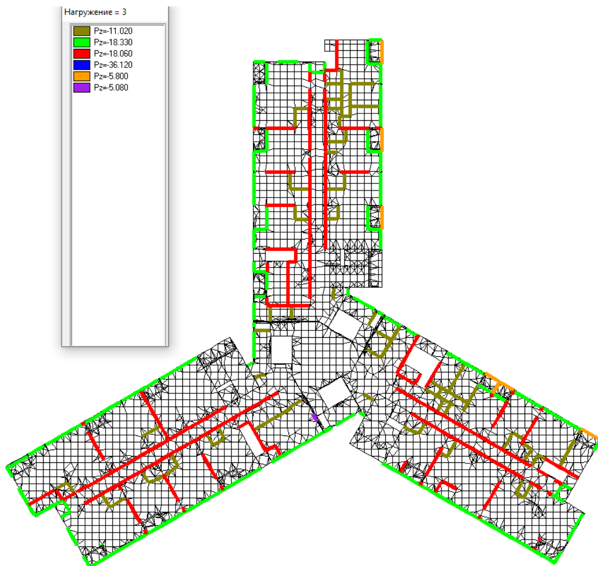
Рис. Нагрузки на плиту перекрытия подвала: нагрузка от стен и перегородок, кН/м
