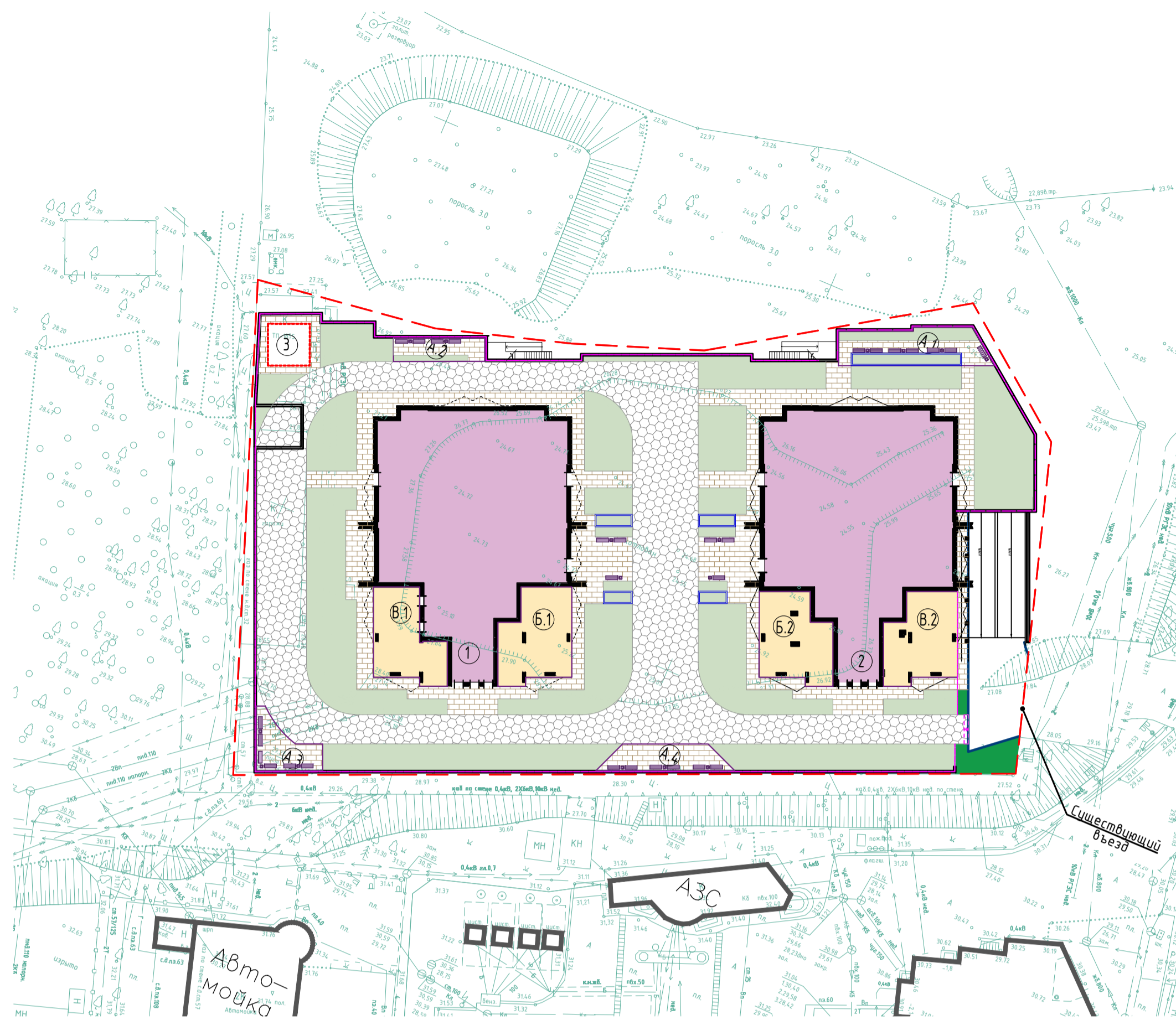
План на уровне эксплуатируемой кровли автостоянки
