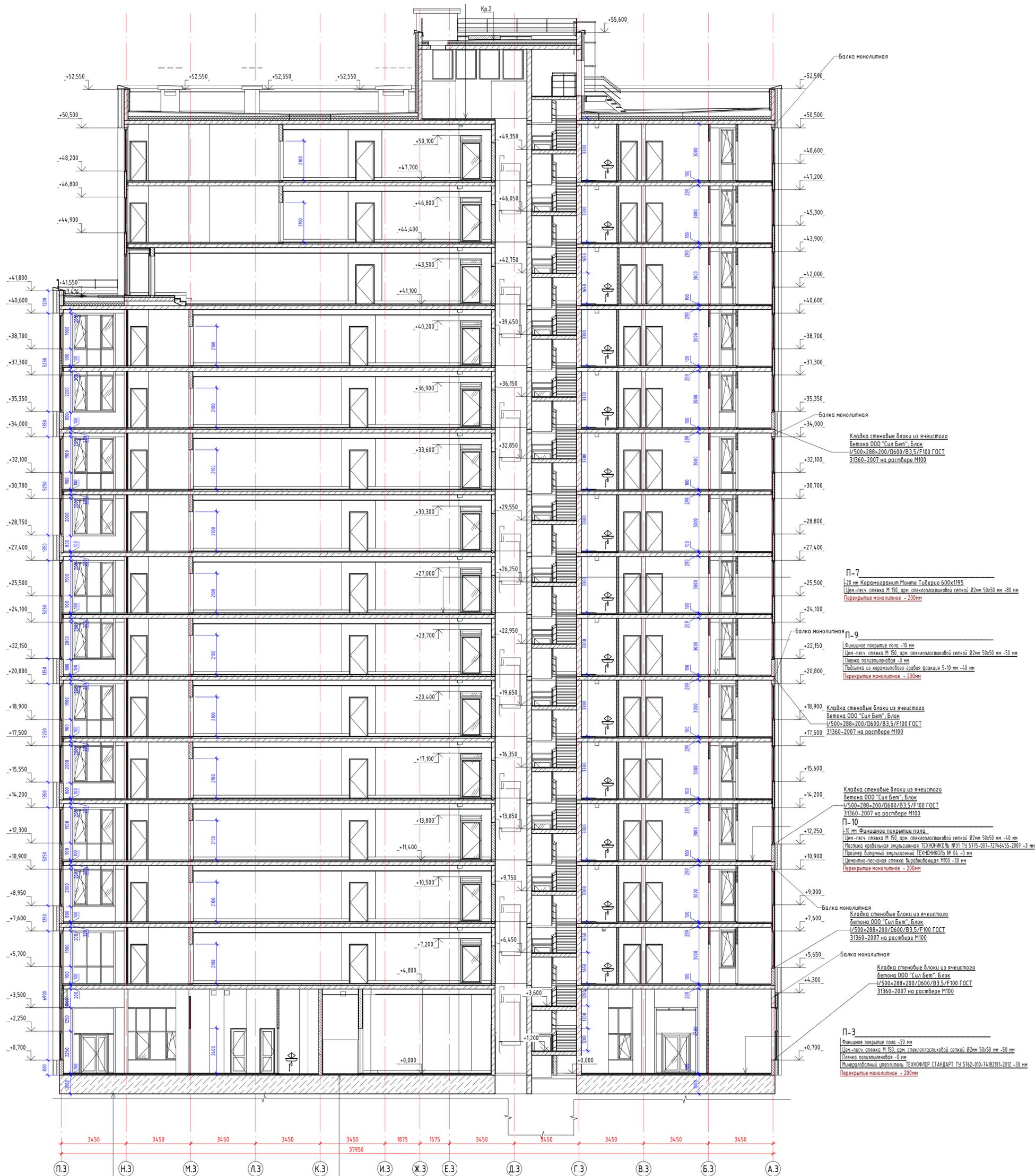
Кладка стеновые блоки из ячеистого бетона ООО "Сил Бет", Блок 1/500x288x200/D600/B3.5/F100 ГОСТ 31360-2007 на растворе М100
