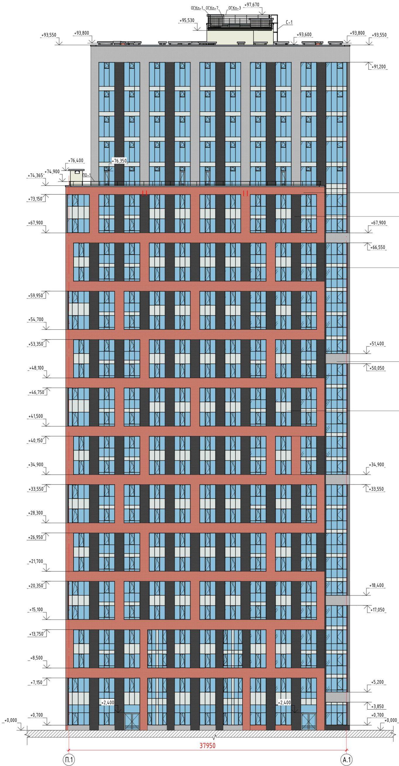
Фасадная клинкерная плитка, 300ммх65мм, (условно красная) кладка ложковая в полкирпича, Ströher, Zeitlos 353
