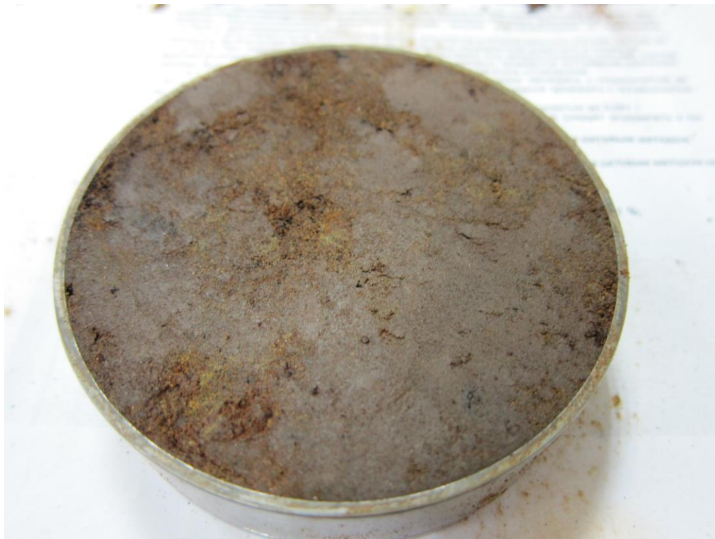
Рис. 5. Суглинок бекетовского горизонта ( laQ_{III-IV}^{bk} ), коричнево-желтый, ожелезненный. Скв. 2, глубина 2,8-3,0м.
