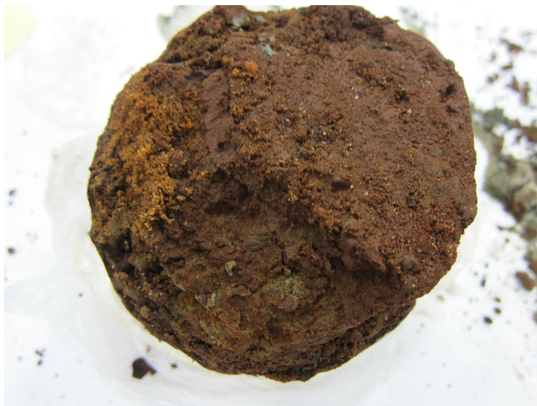
Рис. 6. Песок бекетовского горизонта ( laQ_{III-IV}^{bk} ), средней крупности, желтовато-коричневый, с корочками ожелезнения, на контакте с суглинком. Скв. 2, глубина 3,0-3,1м.
