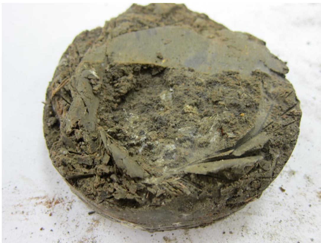
Рис. 4. Глина бекетовского горизонта ( laQ_{III-IV}^{bk} ), серовато-коричневая с зеленоватым оттенком, с гнездами карбонатов, с включением корней растений. Скв. 32, глубина 1,8-2,0м.
