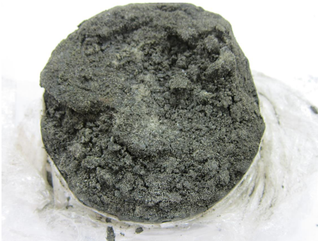
Рис. 12. Песчано-алевритовая порода мечеткинской свиты ( P_2m' ), темно-серая, слабосцементированная, с гнездами серого песка. Скв. 26, глубина 19,2м.
