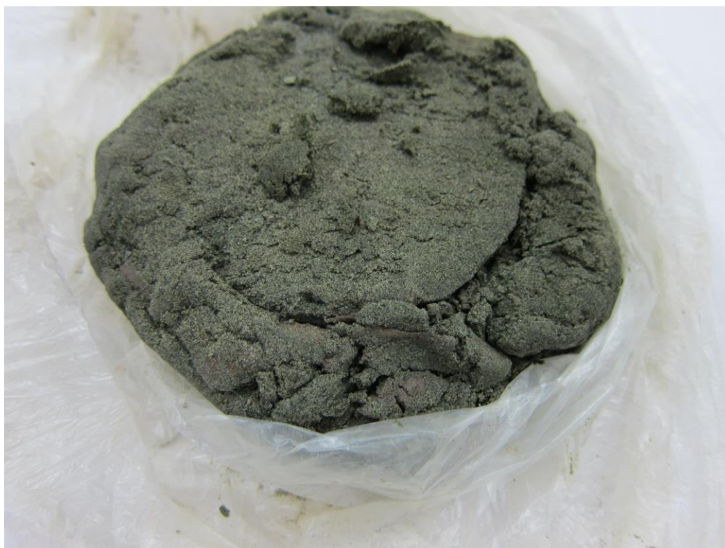
Рис. 8. Супесь хвалынского горизонта ( mQ_{III}^{hv} ), зеленовато-серая, Скв. 32, глубина 15,0м.
