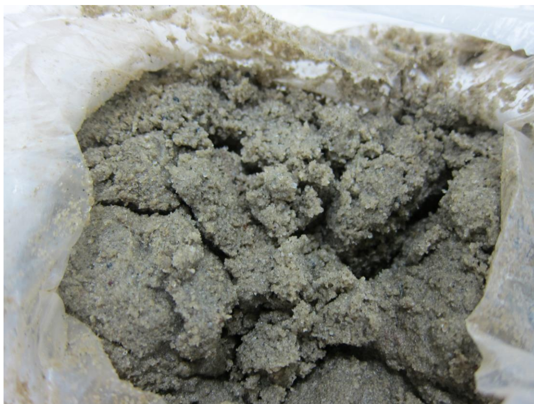
Рис. 10. Песок хазарского горизонта ( aQ_{II}^{hz} ) серый, средней крупности, водонасыщенный. Скв. 2, глубина 17,0м.
