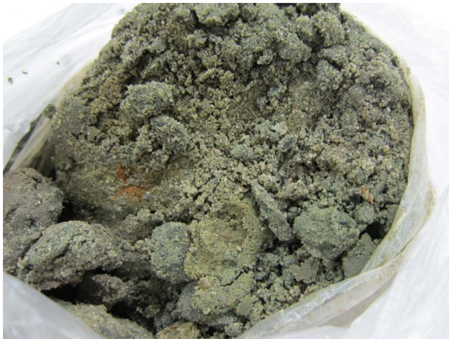
Рис. 11. Суглинок хазарского горизонта ( aQ_{II}^{hz} ) зеленовато-серый, с тонкими прослойками серого песка. Скв. 2, глубина 19,0м.
