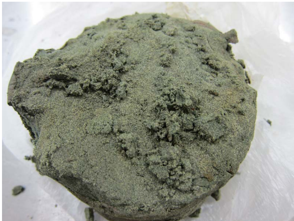
Рис. 9. Песок хвалынского горизонта ( mQ_{III}^{hv} ), зеленовато-серый, пылеватый. Скв. 29, глубина 15,0м.
