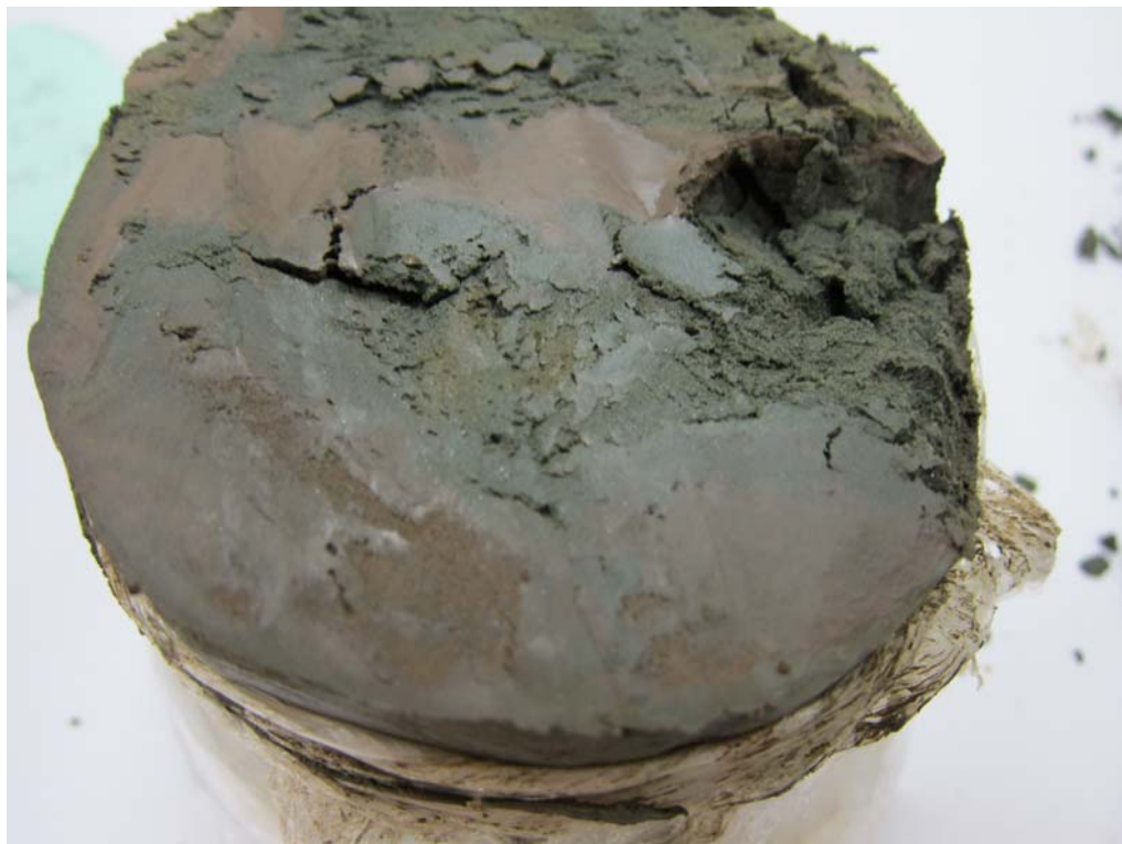
Рис. 7. Суглинок хвалынского горизонта ( mQ_{III}^{hv} ), зеленовато-серый, с тонкими прослойками «шоколадной» глины. Скв. 26, глубина 15,0-15,2м.
