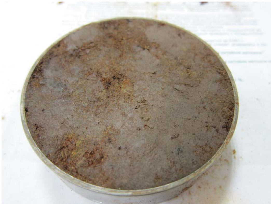
Рис. 5. Суглинок бекетовского горизонта ( laQ_{III-IV}^{bk} ), коричневый, ожелезненный. Скв. 2, глубина 2,8-3,0м.
