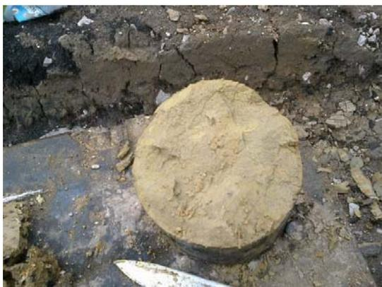
Фото 8. Скважина № 1417, глубина 17 м, элювиальный суглинок с маломощными прослойками песка пылеватого
