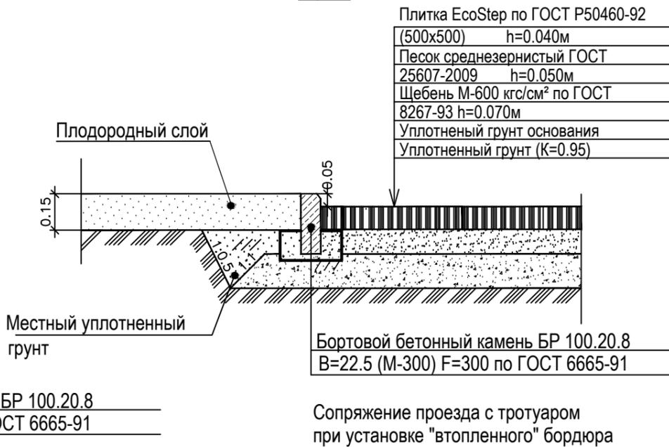
КОНСТРУКЦИЯ АСФАЛЬТОБЕТОННОГО ПРОЕЗДА (Д-1)
