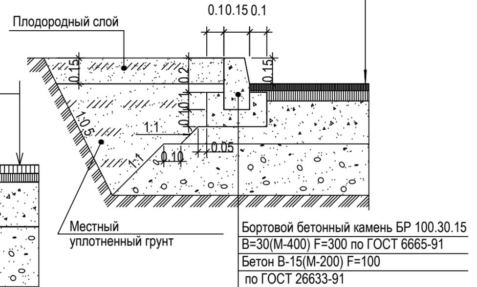
КОНСТРУКЦИЯ БРУСЧАТОГО ПОКРЫТИЯ (Т-1)
